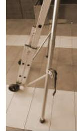
**THE STABILISER CAM MUST BE LOCKED**
